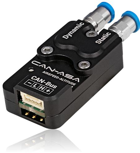
Das CAN-ASA ist ein Airspeed- und Höhensensor, der mit zwei hochpräzisen digitalen barometrischen Sensoren arbeitet. Mit dem statischen Druck wird Höhe und Steigrate berechnet. Die Geschwindigkeit wird aus der Differenz zum dynamischen Druck errechnet. Dadurch ergibt sich ein großer messbarer Geschwindigkeitsbereich bis über 850 km/h und eine Höhenmessung mit 100 mm relativer Auflösung.
