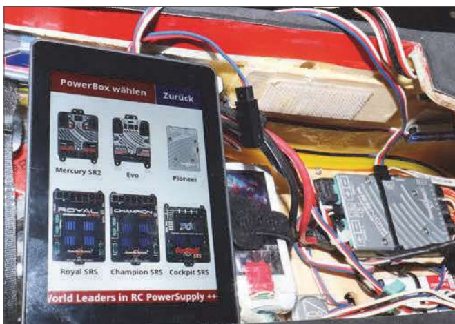
Mit dem Terminal lassen sich PowerBox-Produkte direkt auf dem Flugplatz ohne PC updaten
