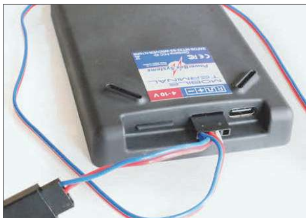
Auf der Stirnseite des Terminals wird der Stecker mit dem beiliegenden Kabel eingesteckt. Über ihn werden das Terminal sowie verschiedene Produkte, mit Strom versorgt
