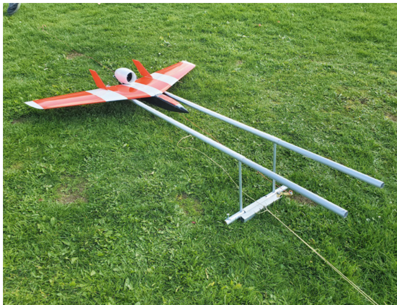
Die Startrampe mit vorderer Auslösemechanik, die über eine Schnur betätigt wird
