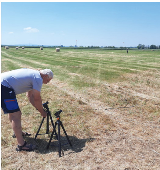
Ralf Becker beim Aufbau der Highspeed-Kameras für die Messanlage, die mit 1.000 Bildern pro Sekunde aufnimmt
