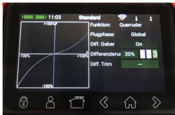
Im Differenzierungsmenü können alle möglichen Servos und Funktionen differenziert werden. Das Menü ist nicht nur auf Querruder begrenzt
