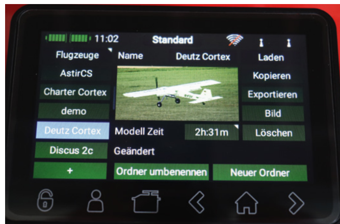
Im Modellmenü wird der gewünschte Modellspeicher ausgewählt. Hier kann auch ein Foto des Modells eingefügt werden
