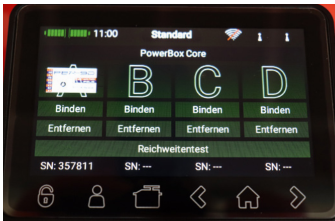
Die Core kann bis zu vier Empfänger pro Modellspeicher binden. In diesem Menü wird auch der Reichweitentest gemacht
