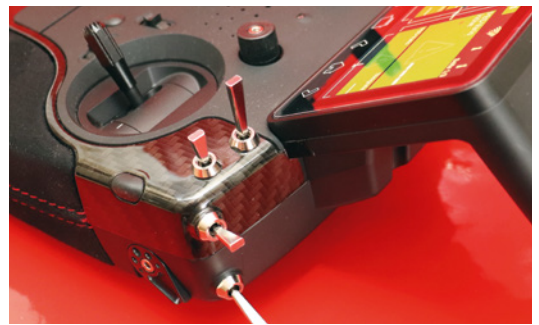
Knüppelaggregate, Schieberegler und Drehgeber sind mit Hall-Sensoren ausgestattet
