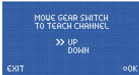
An dieser Stelle wird der Schalter eingelernt. Die **Champion SRS** detektiert den Kanal automatisch, sobald Sie am Sender den Schalter betätigen, den Sie für das Fahrwerk zugeordnet haben. Auf dem Bildschirm sollten die Pfeile vor **UP/DOWN** springen. Sollte ihr Fahrwerksschalter jetzt in der Richtung falsch sein, ändern Sie das, indem Sie im Sender den Ausgang umpolen.
