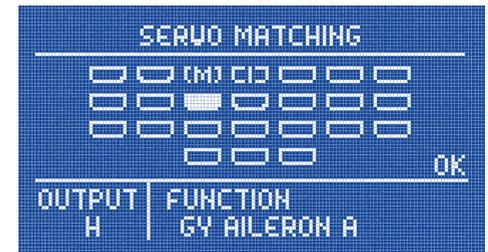
Zu sehen sind der graphisch dargestellte Ausgangsblock, die Kennung des Ausgangs und die zugeordnete Funktion des Ausgangs. Initialisierte Ausgänge sind mit einem **I** gekennzeichnet, bereits gematchte Kanäle mit einem **M**.
