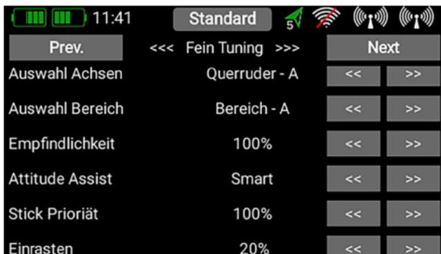
Wählen Sie bei **AUSWAHL Achsen** die zu verstellende Achse aus. Bei **Auswahl Bereich** den gewünschten Bereich. Mithilfe der beiden Bereiche können Sie zwei verschiedene Einstellungen machen, die Sie im Flug mit einem Schalter umschalten können. Der Bereich (**Range**) A wird bei Gainwerten zwischen 0% bis +100% ausgewählt, der Bereich B von 0% bis -100%. Bei 0% ist der iGyro grundsätzlich deaktiviert.
