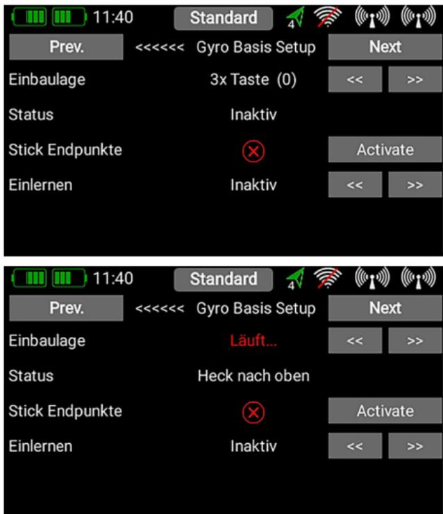
In diesem Bildschirm wird die Einbaulage des **iGyro SAT** und die Null- und Endpunkte der Steuerknüppel eingelernt.
