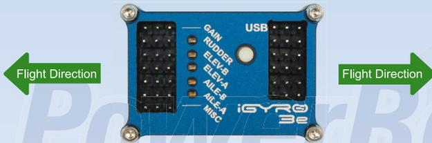
2. Verbinden Sie die Patchkabel mit dem Empfänger und schließen Sie die Servos an.
