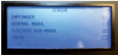
Die Source wird in der mc-32 als »Electric Air-Modul« angezeigt
