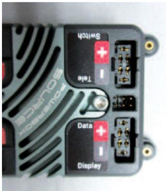
Der Gehäusausschnitt für Telemetrie und USB/BlueCom ist leider falsch, die Kabel müssen anders herum eingesteckt werden. Das geht aber problemlos.
