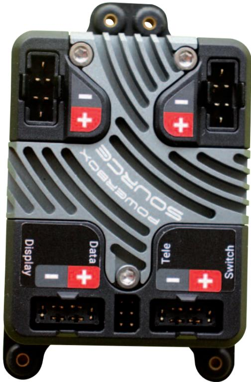
Die PowerBox Source von oben: Links die Akku-Anschlüsse für die Spannungseingänge (Achtung: auf richtige Polung achten), rechts die Ausgänge für die geregelte Spannung, dazwischen die Anschlüsse für USB/BlueCom (unten) und Telemetrie (darüber).
