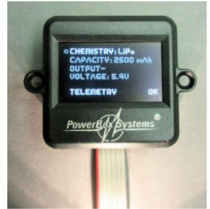
Durch längeren Druck auf die SET-Taste am Schalter gelangt man in das Einstellmenü der Source. Hier kann man die Ausgangsspannung und das Telemetriesystem einstellen.
